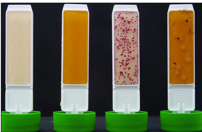
Cult-Dip combi (Dip-Slide). Auf der linken Seite die beiden unterschiedlichen Nährböden (TTC-Agar und Kartoffel-Glucose-Agar), rechts der bebrütete Stift mit Keimen (zirka 10<sup>6</sup>) und Hefen und Schimmelpilzen (zirka 10<sup>3</sup>).
